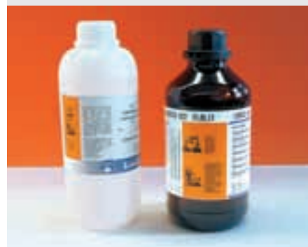
Slika 37 Koncentrirano raztopino amoniaka hranimo v plastični ali stekleni posodi. Na nalepki so oznake za jedko in nevarno za okolje.
