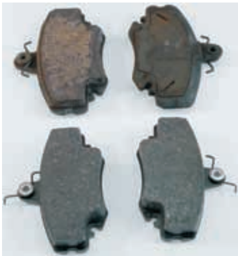
Slika 15 Po dolgotrajni uporabi zavornih ploščic so zavorne obloge povsem obrabljene.
