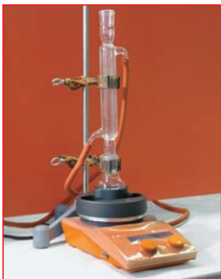
Slika 5 Organske sinteze pogosto izvajamo v bučki s povratnim hladilnikom.
