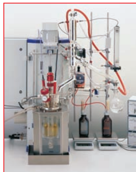
Slika 4 V laboratoriju izvajamo kemijske sinteze v ustreznih aparataturah, ki omogočajo mešanje reaktantov, segrevanje ali ohlajanje reakcijske zmesi, delo pod inertno atmosfero itd.
