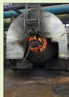
Taljenje odpadnega svinca v bobnasti peći
