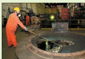
Odstranjevanje nečistoč iz surovega svinca (rafiniranje)
