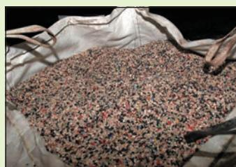
Opran in zmlet plastični material ohišij akumulatorjev, pripravljen za nadaljnjo predelavo
