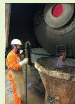
Izlivanje staljenega svinca iz bobnaste peći
